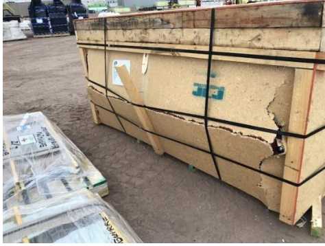
Cajón con maderas débiles para soportar Cajas sueltas, el peso de la carga en su interior.
