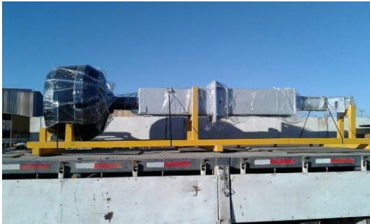
Componente (Dardo) cuyo Atril no cuenta con las calzas para la uñas de la Grúa Horquilla. Los zunchos no son suficientes, por el peso para la sujeción del componente sobre el atril. Las vibraciones durante el transporte pueden sacar de su calzo el componente
