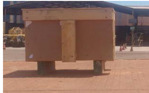
Cajón no cumple con el estándar de palletizado. La cavidad no permite tomar con las dos uñas de la Horquilla. Al tomarla con sólo una uña hay evidente riesgo de caída del cajón.
