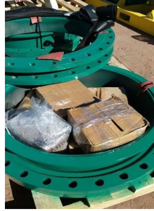
Cajón con maderas débiles para soportar Cajas sueltas, el peso de la carga en su interior.
