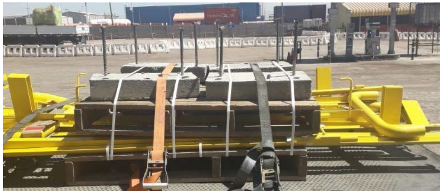
Componente (Dardo) cuyo Atril no cuenta con las calzas para la uñas de la Grúa Horquilla. Los zunchos no son suficientes, por el peso para la sujeción del componente sobre el atril. Las vibraciones durante el transporte pueden sacar de su calzo el componente
