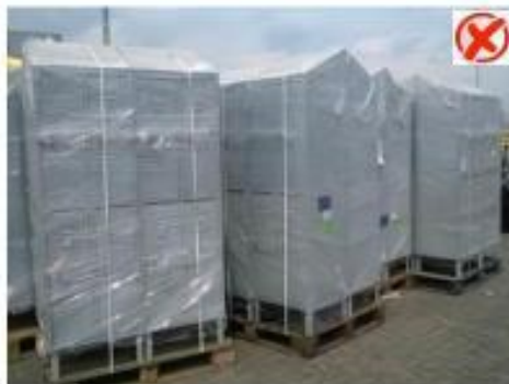
Estructura frágil sin jaba y sin rotulo
