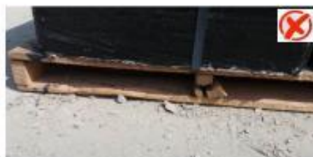
Pallet en mal estado
