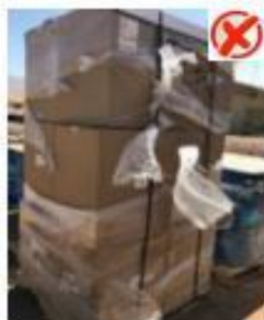
Film dañado y altura super 1,20 mts
