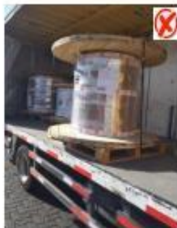
Carga sobresale del pallet
