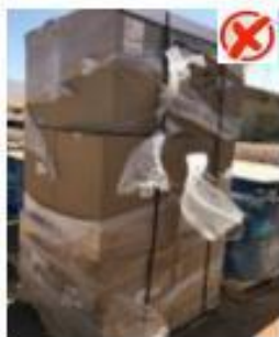
Film dañado y altura super 1,20 mts
