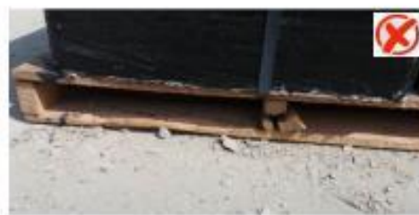
Pallet en mal estado
