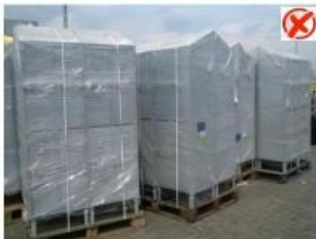
Estructura frágil sin jaba y sin rotulo
